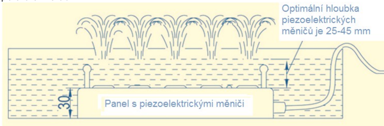
Obr. Umístění panelu s měniči pod hladinou vody
